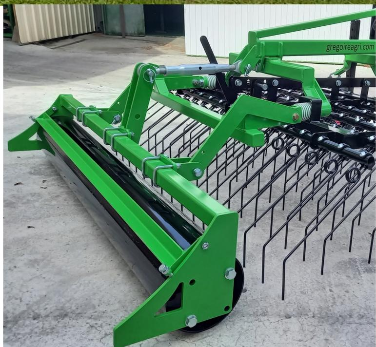
**Lame de désherbage, béquilles manivelles et rouleau de réappuyage avec semoir**
