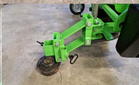
Tête rotofil sur parallélogramme rétractable
