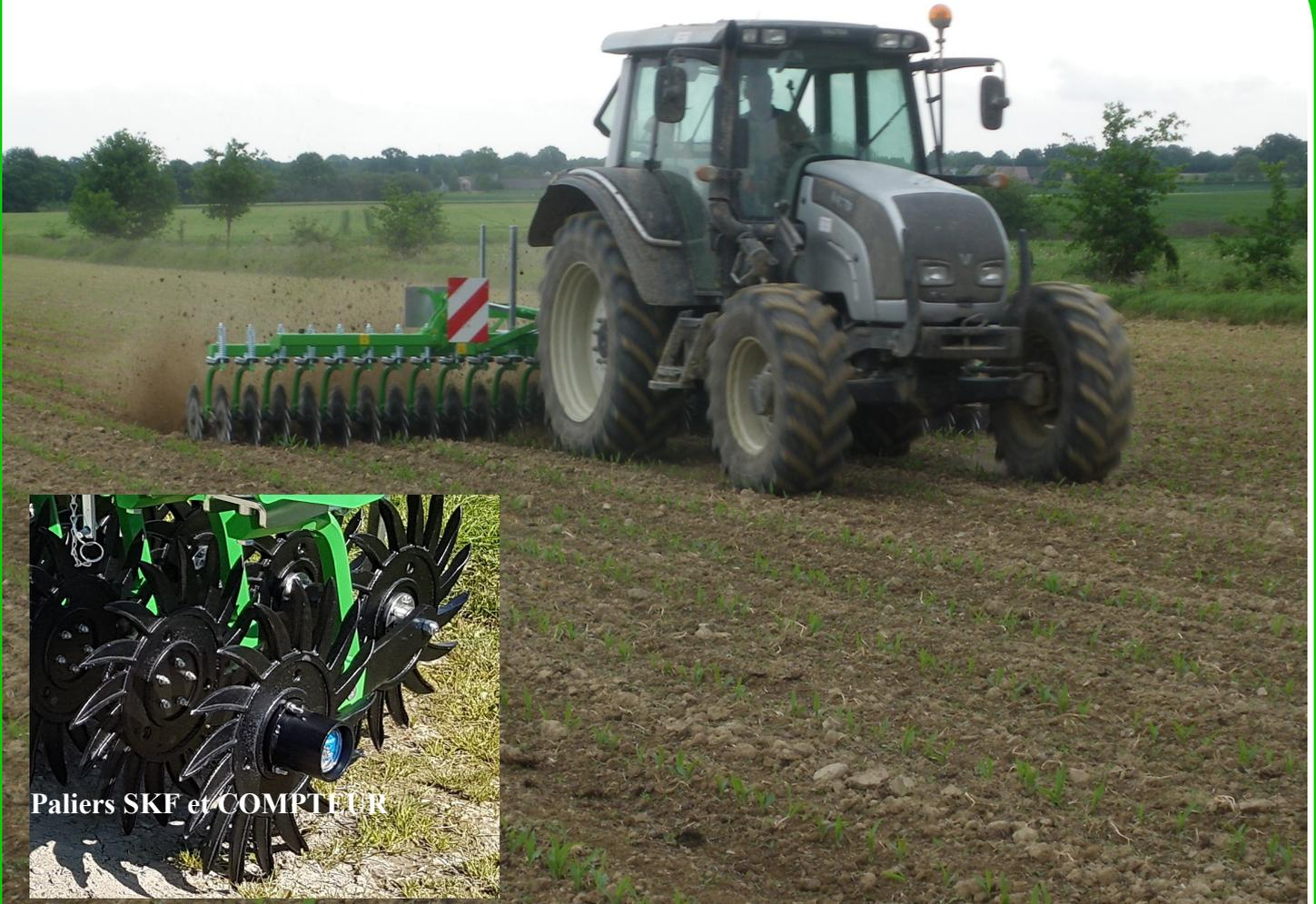
La houe rotative est destinée à écrouter, aérer et désherber les cultures. La vitesse de travail élevée, de l'ordre de 10 à 15km/h, assure un débit de chantier important. Un passage précoce permet le déracinement des adventices au stade fils blancs. Nos houes disposent d'options, d'équipements différents selon l'usage recherché.
