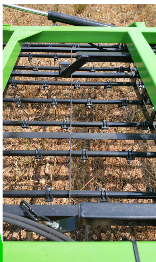
Herse GD 12,50, 5 panneaux de 2,50m, dents de 600mm, 6 roues de jauge avant, 2 roues AR, 3m repliée
